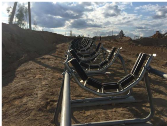
Слика 70 Носечки слог од 5 валци на транспортната лента и мост за премин на луѓе
