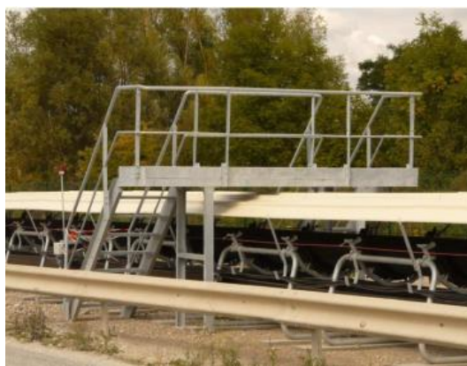
Слика 70 Носечки слог од 5 валци на транспортната лента и мост за премин на луѓе
