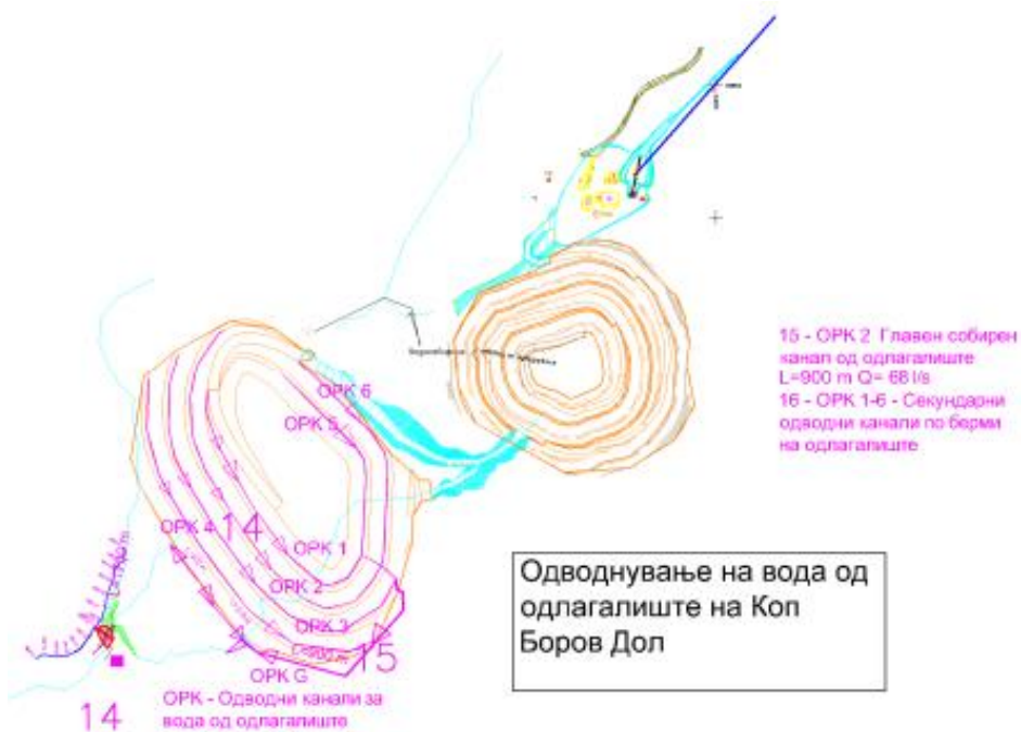
Слика 93 Шема на систем за одводнување на одлагалиште
