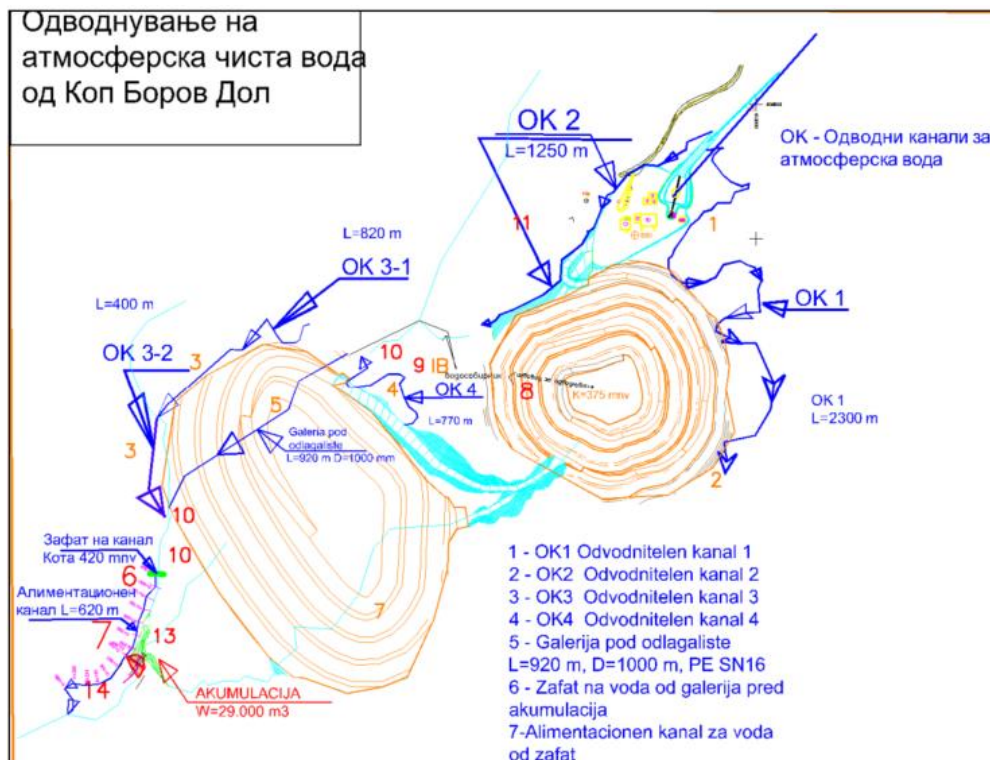
Слика 94 Прегледна шема на системи за одводнување на атмосферски чисти води од рудник „Боров Дол“
