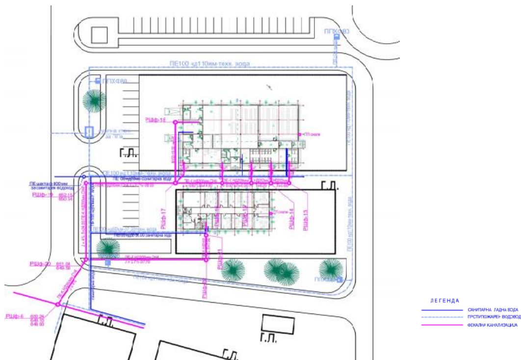
Слика 46 Шематски приказ на поврзаноста на Управната зграда со водовод и канализација
