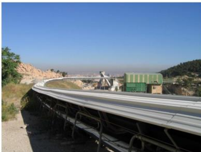
Слика 69 Криволиниски лентест транспортер
